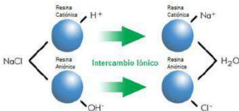
En ocasiones, en los sistemas de tratamientos se incorporan tanto resinas catiónicas como resinas aniónicas, dispuestas en una misma columna o lecho. Los equipos utilizados para el tratamiento por intercambio iónico son columnas o tanques provistos
